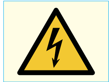
Bild 1: Warnung vor gefährlicher elektrischer Spannung
